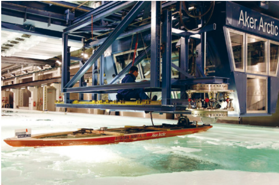
Kuvassa testataan Aurora Borealis -laivan mallia Aker Arctic Technology Oy:n jäälaboratoriossa Helsingin Vuosaarella.
