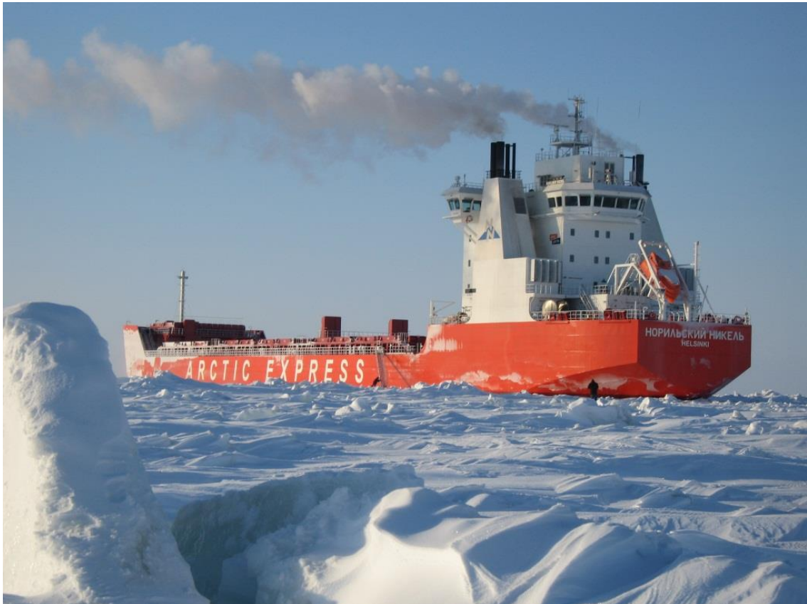
Kuva 2. Norilsk Nickel –alus Koillisväylällä. Helsingin telakalta valmistui Norilsk Nickel –niminen laiva vuonna 2006 Koillisväylän liikenteeseen. Laiva on innovaatio monin tavoin, muun muassa se pystyy kulkemaan jäissä ilman jäänmurtajan apua 1 . Se kuljettaa malmia Jenisei-joen varren Dudinkansta Murmanskiin konteissa. Kustannuksia ja ympäristöä säästävät teknologisten ratkaisujen kehittyminen on
